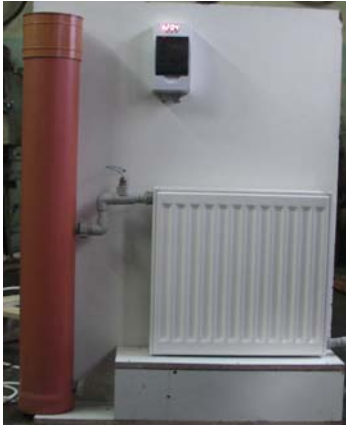
Проточний нагрівач води потужністю 3 кВт
