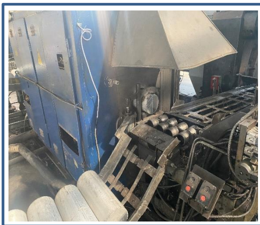
Індукційна установка для градієнтного нагрівання алюмінієвих заготовок перед пресуванням
