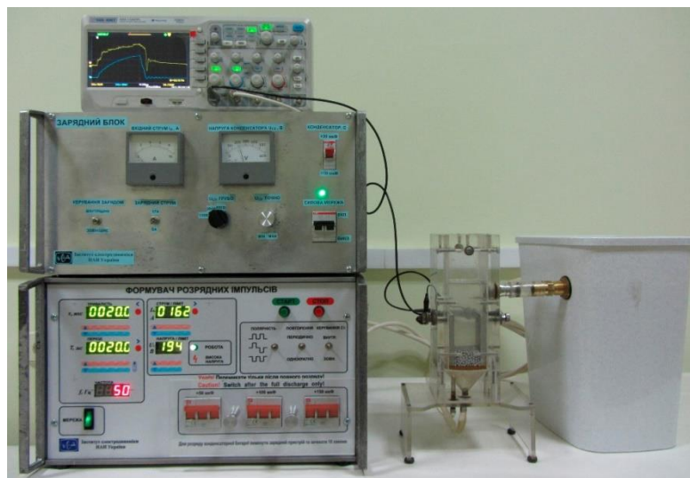
Лабораторна установка плазмоерозійної обробки гранульованих струмопровідних середовищ
