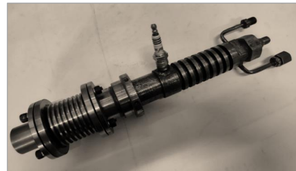
Малогабаритний імпульсно-детонаційний двигун ( \approx 10 Н)
