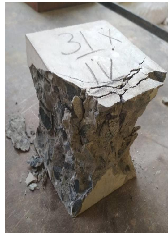
Випробування радіаційно-захисного бетону на міцність
