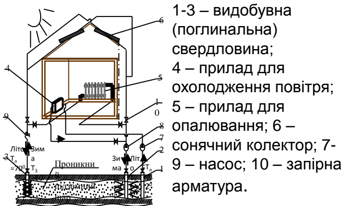
Приклад сонячно-геотермальної системи теплопостачання
