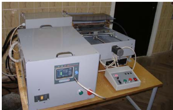
Установка індукційного нагріву потужністю 80кВт та частотою 66 кГц для поверхневого загартування металевих плит
