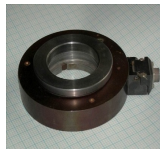
1 – місце встановлення і 2 – сам перетворювач зусиль для статора турбогенератора ТВВ-220-2АУЗ
