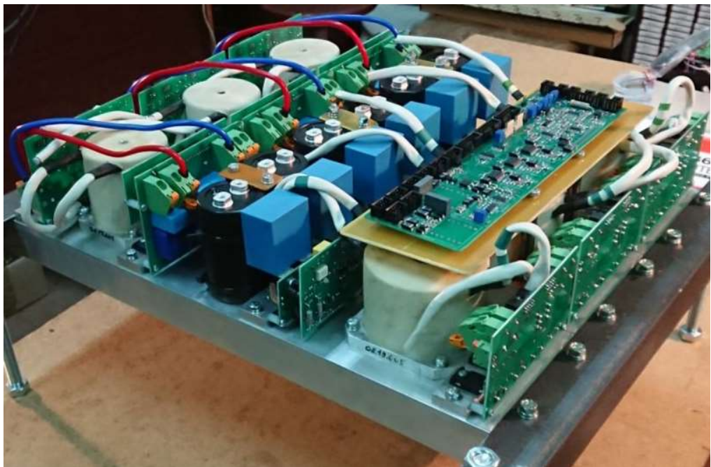
Рис. 4.8 Паралельне з'єднання трьох 6кВт двонаправлених перетворювачів
