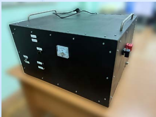
Імітатор стандартизованої мікросекундної імпульсної перешкоди (CWG 1.2/50–8/20 мкс)
