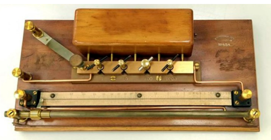
Рис. 1.1 Міст Кольрауша для вимірювання ЕПР електролітів
