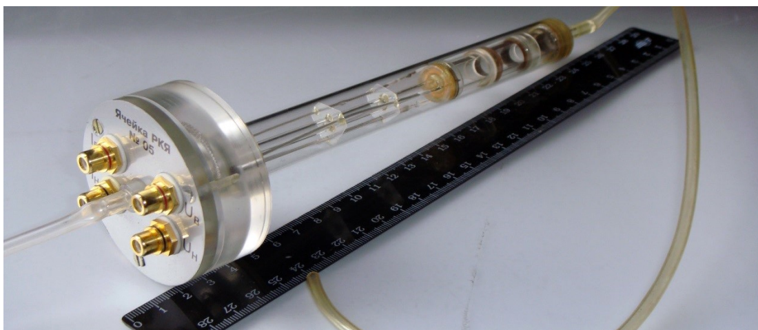
Рис. 1.14 Загальний вигляд чотириелектродної КК змінного струму ДП “Укрметрестандарт”.
