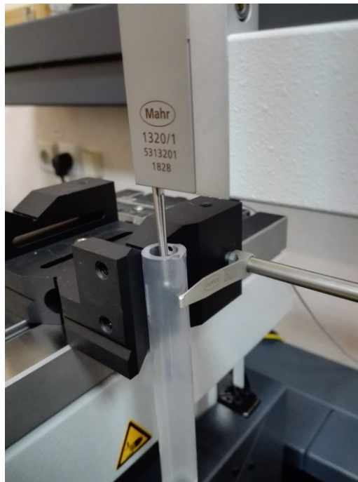
Рис. 5.4 Вимірювання внутрішнього діаметра кварцових трубок ДКК Джонса автоматизованою вимірювальною системою Precimar PLM 1000-E.
