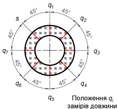
Рис. 5.6 Розташування положень замірів довжини на торцях трубки.
