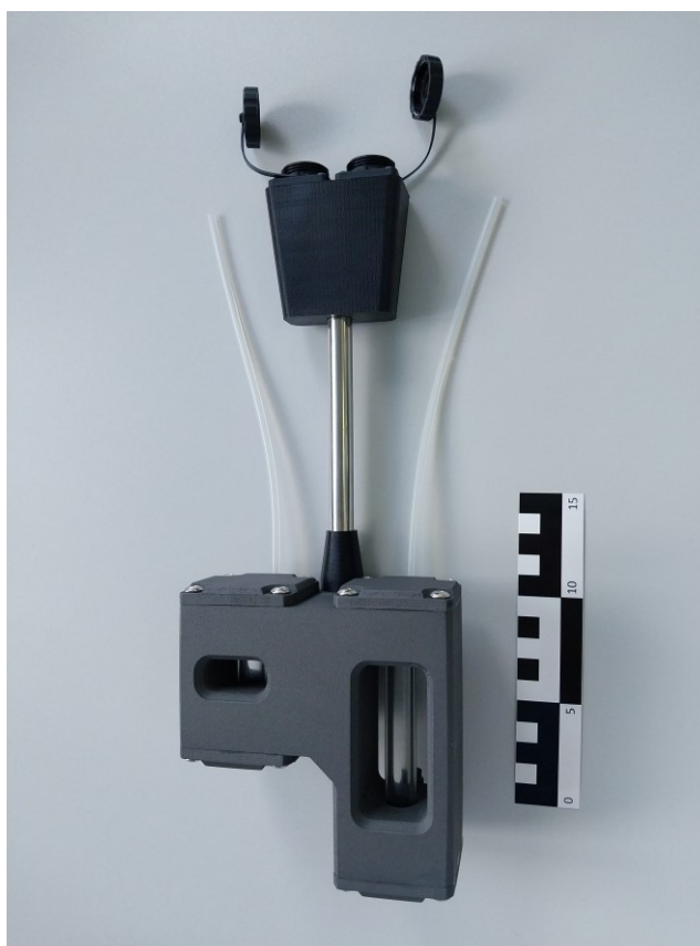
Рис. 5.1 Зовнішній вигляд ДКК Джонса із двома парами електродів та бічним підведенням рідини.
