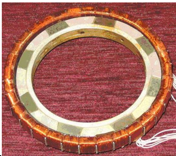
Рис. 1.16 — Безкорпусний моментний двигун з радіальним магнітним потоком та масивним ярмом статора (Інститут електродинаміки НАН України)
